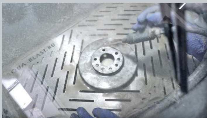
Камера аквабластинга позволяет быстро и качественно очистить различные поверхности от загрязнений
